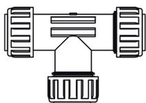
Acople de compresión plástico (Junta Dresser) para reparar o conectar en forma rápida y sencilla todo tipo de caños, ya sean plásticos o de otros materiales.
